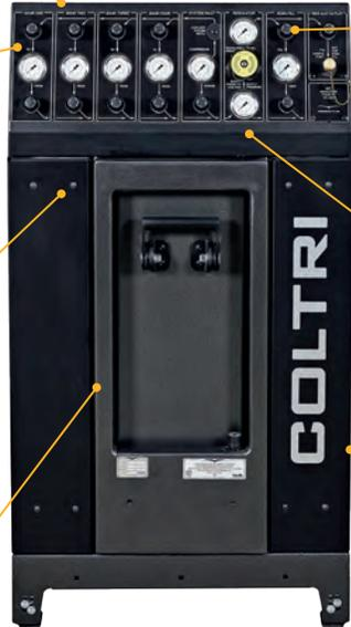
Commandes en vrac ou en cascade avec régulateur APRIA et vanne de remplissage
