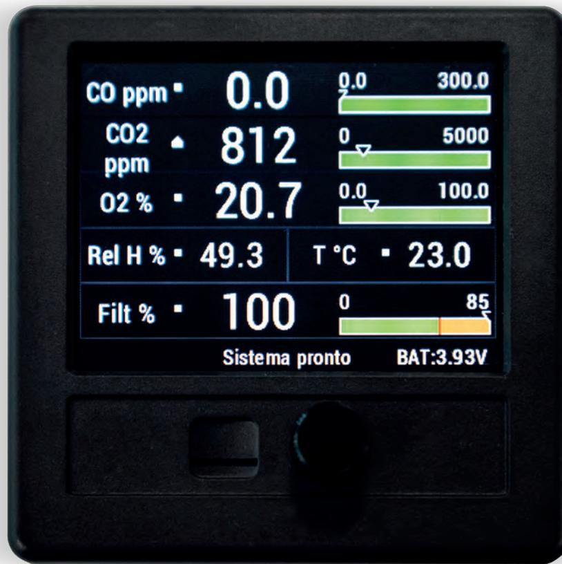
Le Système d'Analyse Multigaz (SAM) est un instrument de mesure relié à un grand nombre de capteurs. Il est capable de détecter des concentrations aussi faibles que 5 ppm (parties par million), conformément aux normes NFPA. Il est principalement utilisé pour la surveillance continue des gaz ambiants. La configuration standard comprend :
