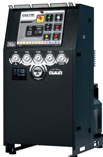
Le cœur de la machine est le GP 650, le compresseur 4 étages le plus puissant de Coltri, équipé d'inter-refroidisseurs et d'une pompe à huile, avec arrêt automatique et purge des condensats. Conçu pour un usage intensif, il offre une capacité de remplissage allant jusqu'à 27 cfm à 6000 psi.
