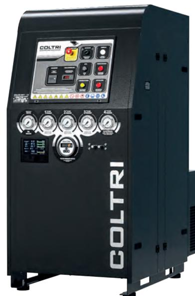
Le cœur de la machine est le GP 650, le compresseur 4 étages le plus puissant de Coltri, doté d'inter-refroidisseurs et d'une pompe à huile, avec arrêt automatique et purge automatique des condensats. Conçu pour un usage intensif, il offre une capacité de remplissage allant jusqu'à 27 cfm à 6000 psi.
