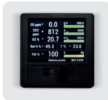
Le SAM Multigaz est basé sur un capteur électrochimique de monoxyde de carbone de dernière génération. Il s'agit d'un instrument de mesure entièrement numérique, doté d'alarmes visuelles et sonores en cas de détection de monoxyde de carbone, de dioxyde de carbone ou d'humidité au-delà des seuils préétablis (en ppm). En cas de dépassement, le système déclenche l'arrêt automatique de la machine.
