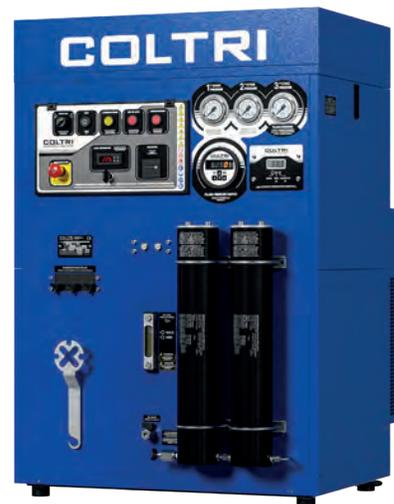
Le cœur de la machine est le GP 315 TPS de Coltri, un compresseur à 3 étages équipé d'inter-refroidisseurs et d'une pompe à huile, avec arrêt automatique et purge automatique des condensats. Il offre une capacité de remplissage allant jusqu'à 13,4 cfm à 6000 psi.
